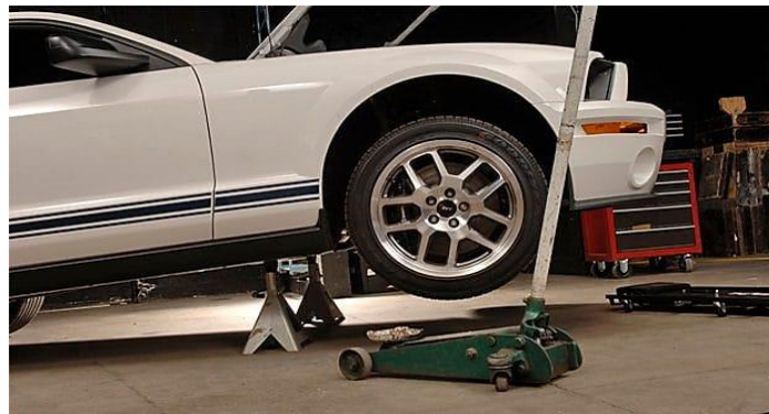
Figura 4.1: Embancar el vehículo. Fuente: (PENNZOIL, 2019).
