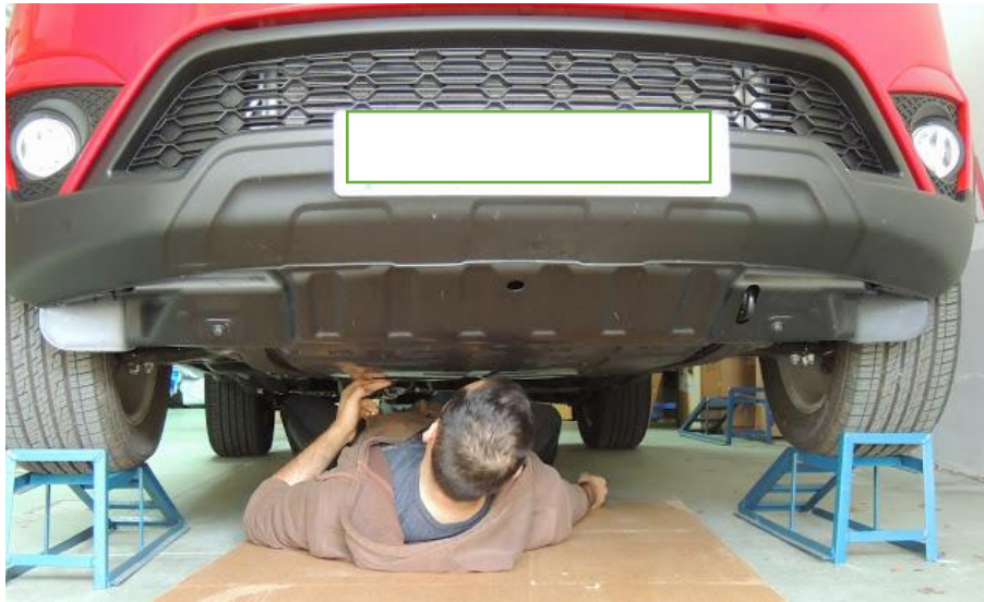
Figura 4.8: Rampa para el cambio de aceite de un vehículo. Fuente: Internet
