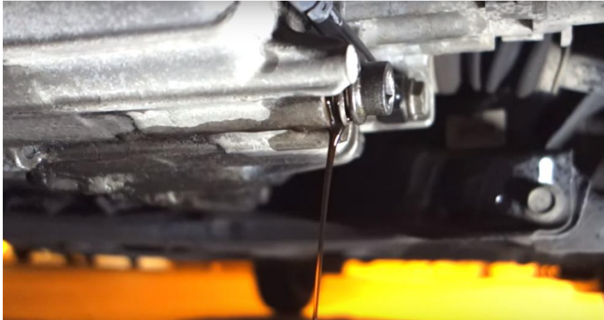
Figura 4.10: Vaciado del aceite. Fuente: Internet.
