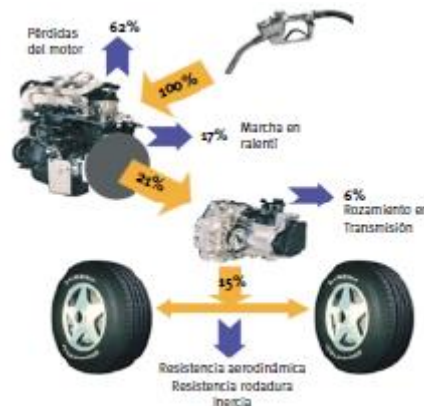
Fig. 4.20: Pérdida de energía en el vehículo. Fuente: (Instituto para la Diversificación y Ahorro de la Energía (IDAE) para el Parque Móvil del Estado, 2002).
