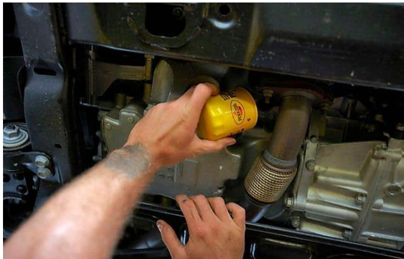
Figura 4.5 Colocación del Filtro de aceite. Fuente: (PENNZOIL, 2019).
