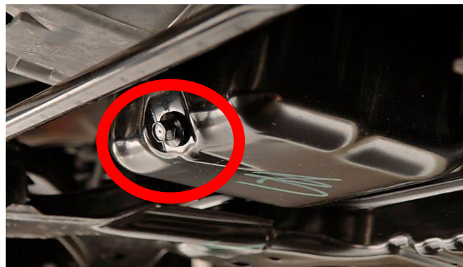
Figura 4.2: Perno de drenado. Fuente: (PENNZOIL, 2019)
