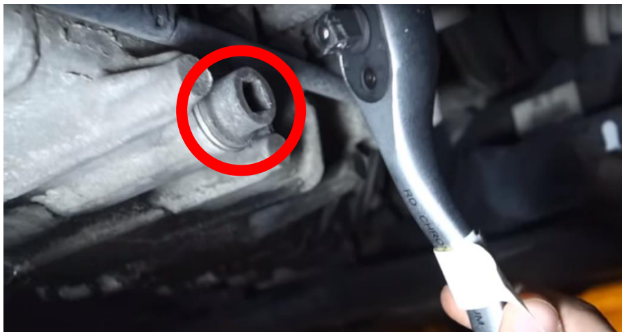
Figura 4.9: Tapón de vaciado del aceite. Fuente: Internet.
