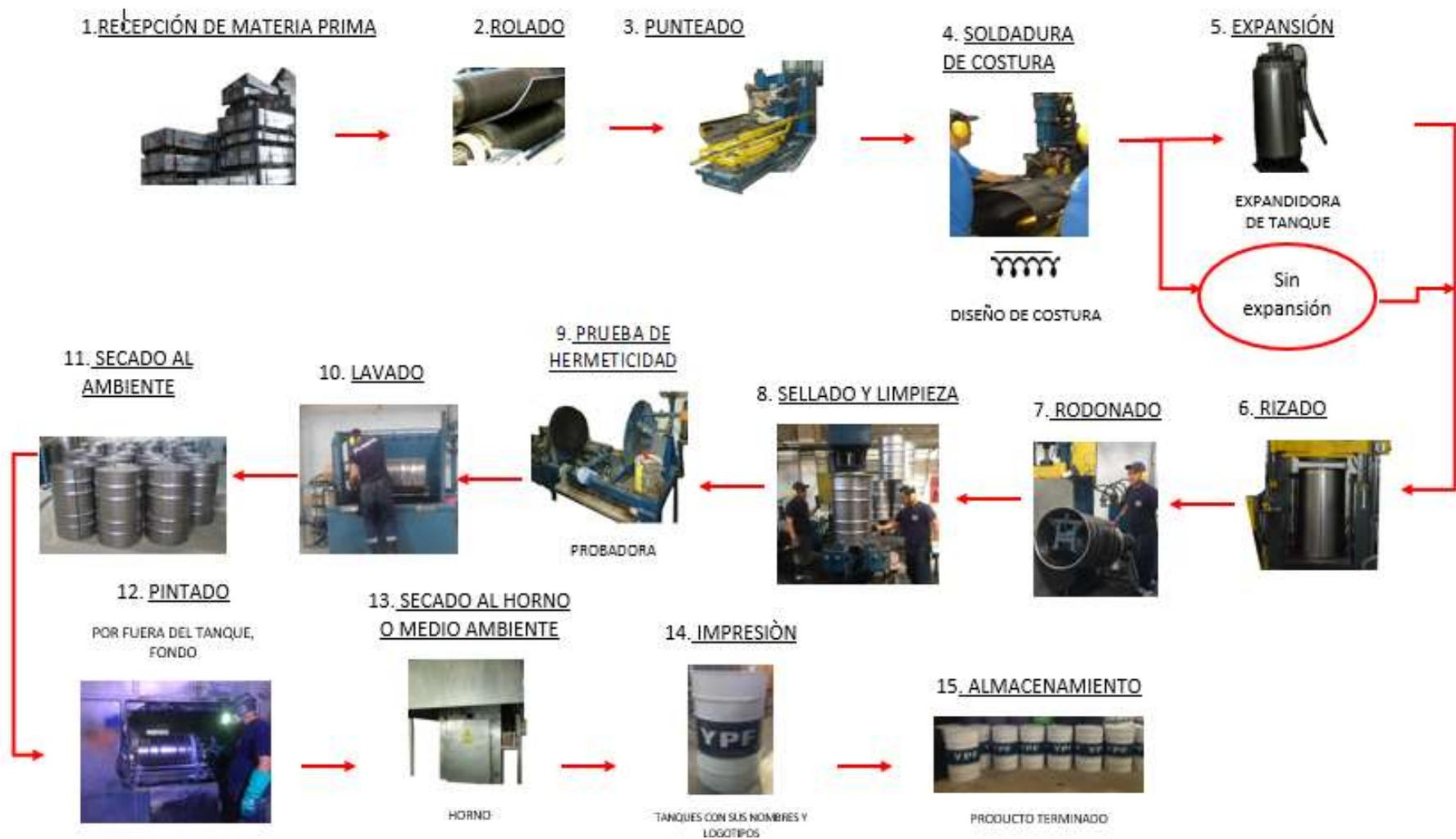
**Figura 4** Diagrama esquemático del proceso de la fabricación de los tambores metálicos cilíndrico sellado
