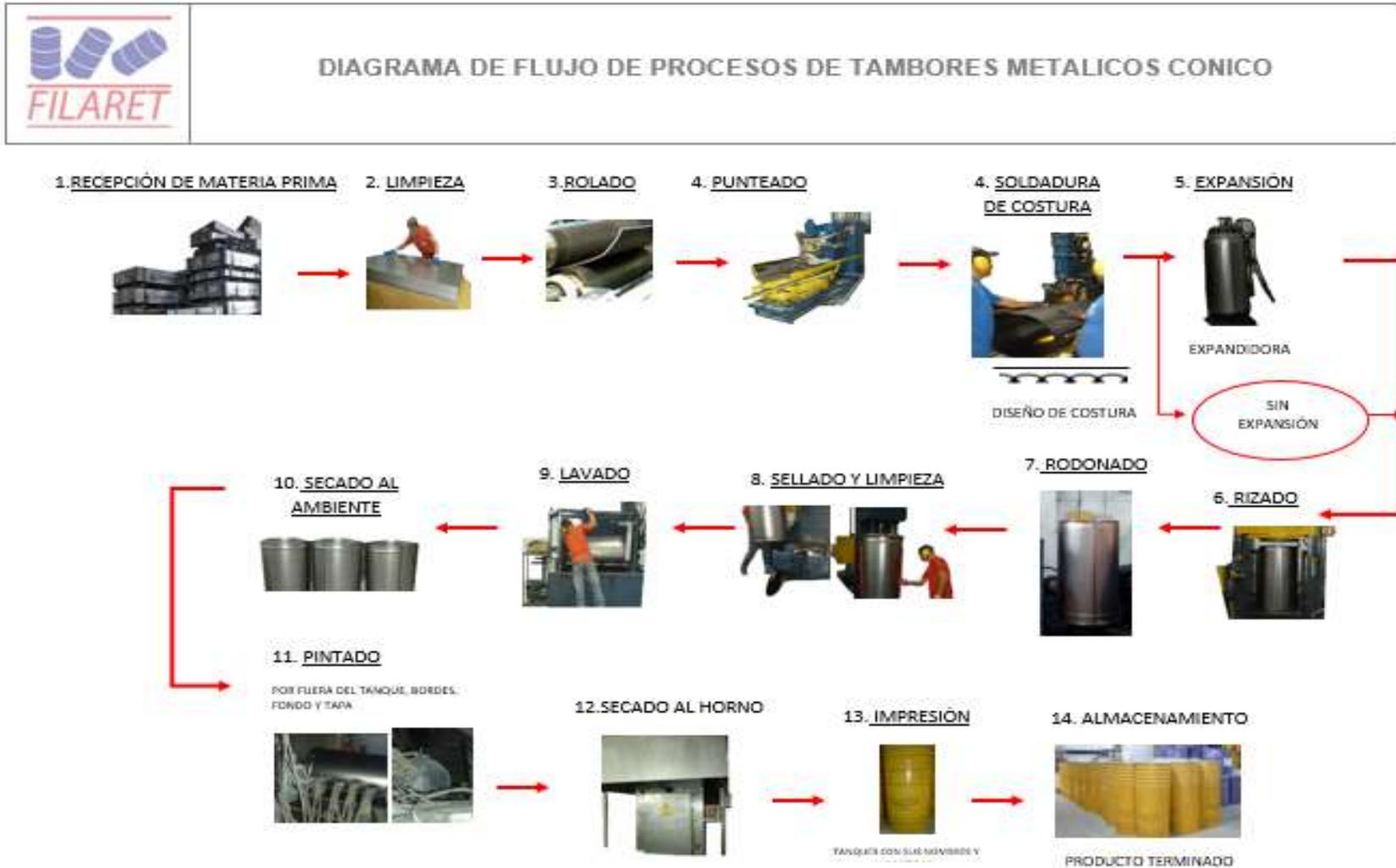
**Figura 5** Diagrama esquemático del proceso de la fabricación de los tambores metálicos cónico abierto
