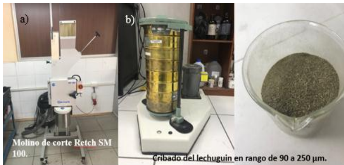
Ilustración 8. a) Molido y pulverizado de la muestra seca de jacinto de agua en un molino de corte Retsch SM 100. b) Cribado de la muestra en un rango de 90 a 250 \mu\text{m} .
