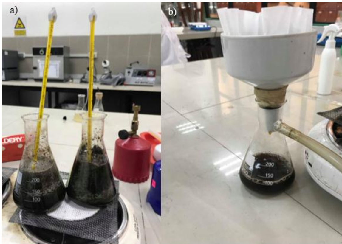
Ilustración 11. a) Inactivación del Trichoderma spp mediante pasteurización a 80°C por quince minutos. b) Filtrado al vacío del producto sacarificado.
