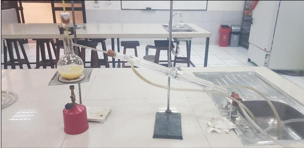
Ilustración 10. Equipo de destilación para la recuperación de ácido láctico
