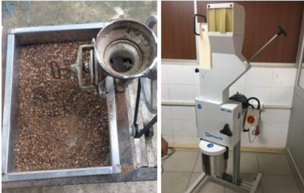
Ilustración 11. Molinos empleados para la disminución de partícula de la cáscara.
