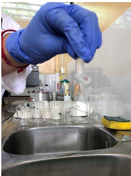
Figura 60 Sobrenadante desechado con cuidado, para la obtención del pellet
