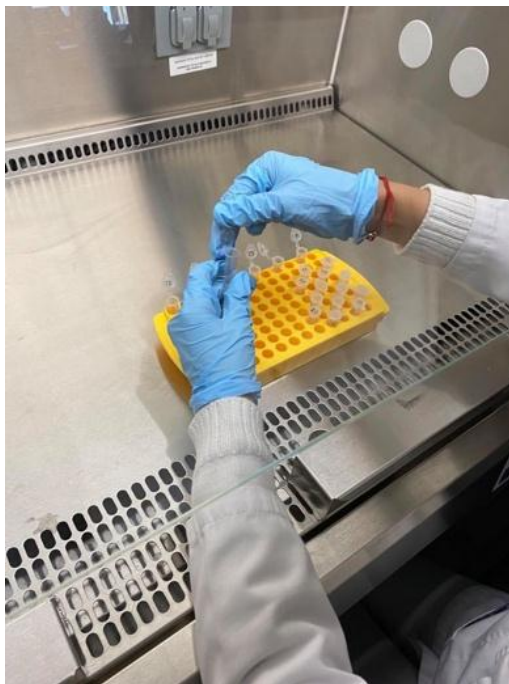
Figura 64 Tubos cónicos con tapas abiertas dentro de una campana de extracción para secado del precipitado.
