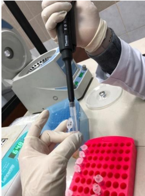
Figura 79 Transferencia del sobrenadante a otro tubo
