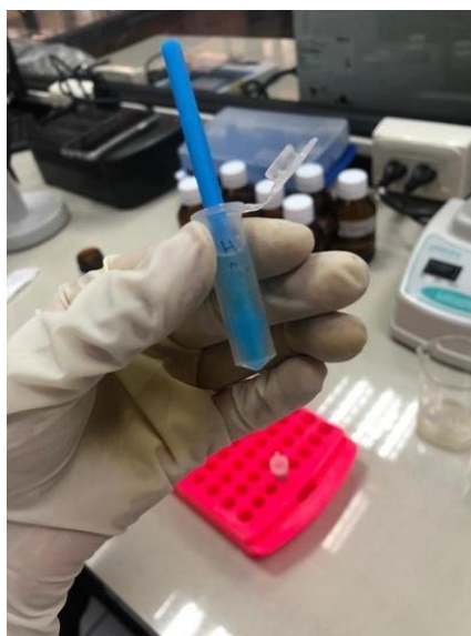
Figura 44 Macerado de la muestra mezclada con TEN
