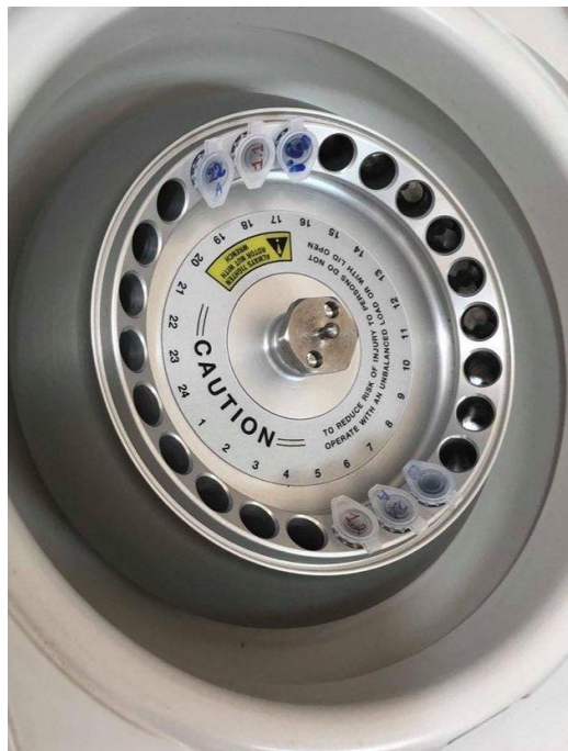
Figura 62 Interior de centrifuga donde las muestras son colocadas de manera que no se ocasione un desequilibrio
