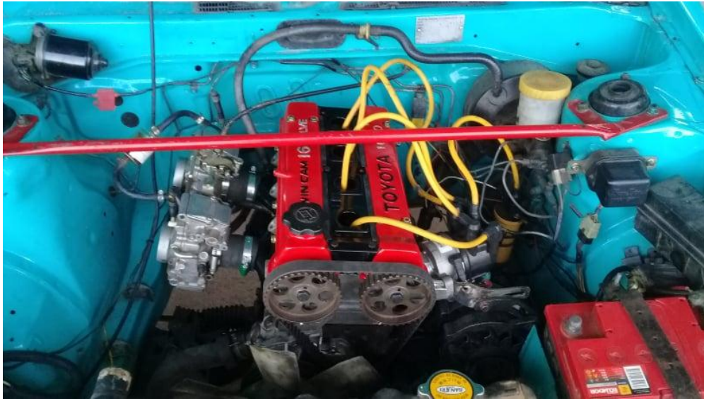
Figura 49 Motor de 16 válvulas montado en el vehículo.
