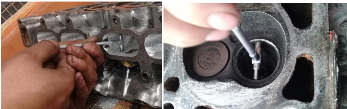
Figura 17 Verificación de los diámetros con palpadores de interiores.
