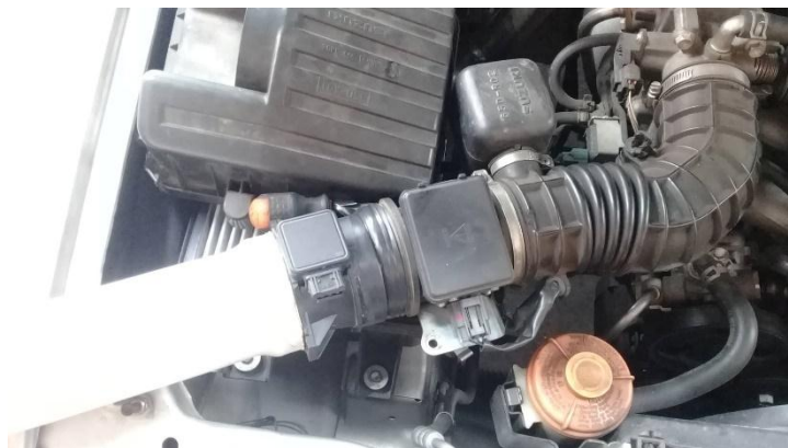
Figura 10 Intake con dos sensores MAF en el vehículo Vitara.
