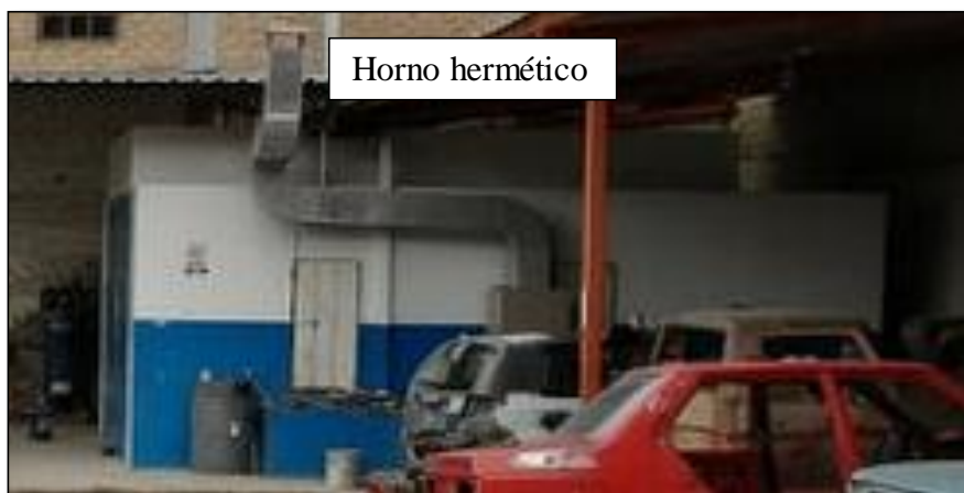
Imagen 10. Horno hermético para la fase de pintado. Elaboración: Autor
