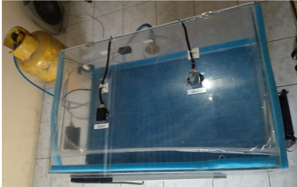
Figura 4.5: Ubicación de los sensores de gas
