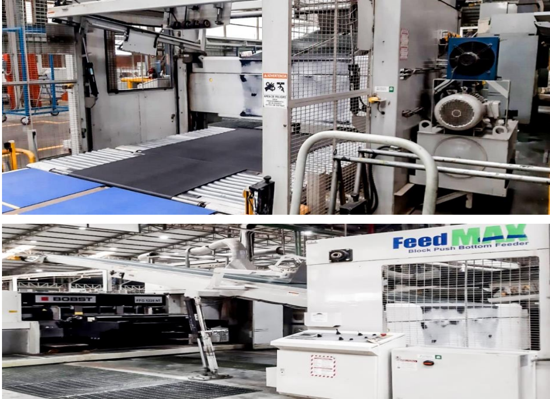
Figura No. 2 Alimentadora Inferior de Empuje Fuente: Los Autores
