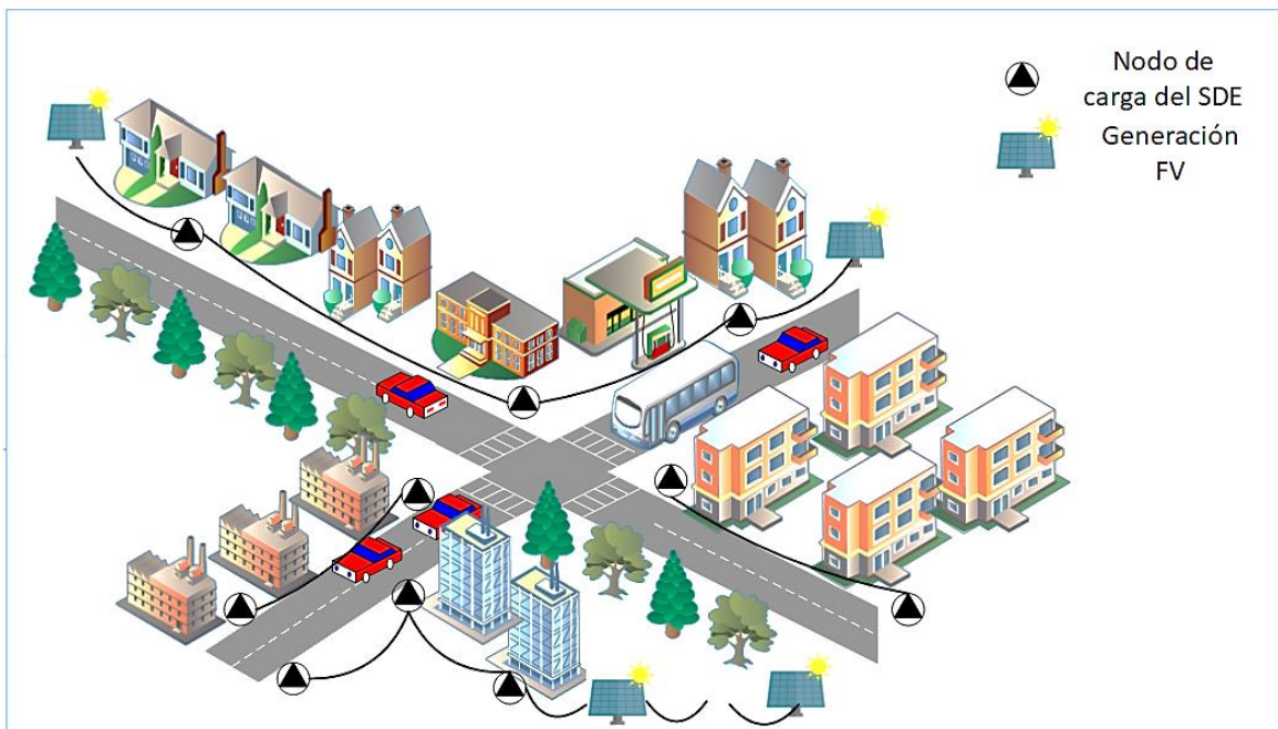
Figura 1 Microred de distribución con implementación de GD
