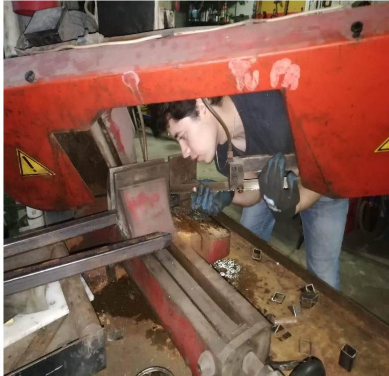
Cortes de tubo para la estructura de la fumigadora
