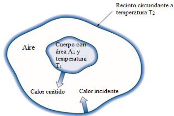
Figura 8. Transferencia de calor por radiación entre un cuerpo y el ambiente circundante [55], [57].
