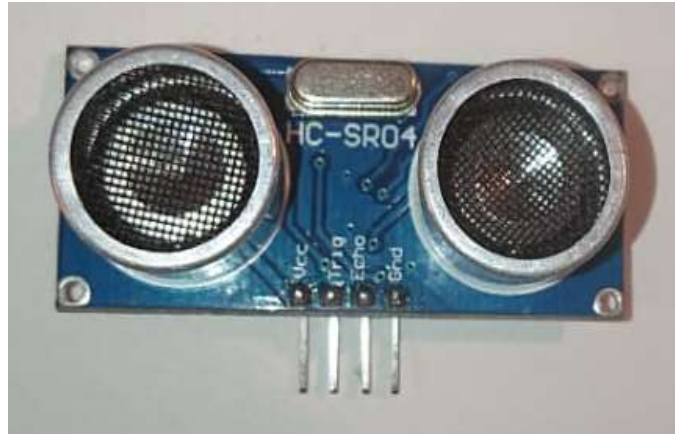
Figura 2. Sensor ultrasónico para medir distancia. Elaborado por: Junior Ramos y Rodrigo Vaca
