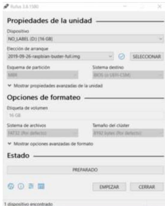
Figura 19. Instalación de la ISO en el micro sd con el programa Rufus. Elaborado por: Junior Ramos y Rodrigo Vaca
