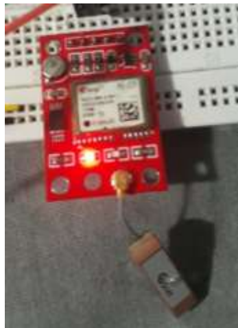
Figura 14. Modulo GPS NEO 6M. Elaborado por: Junior Ramos y Rodrigo Vaca
