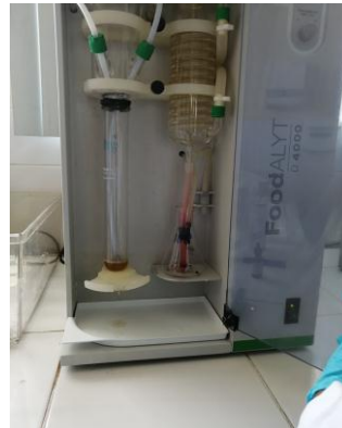
Kjeldahl para proteína: J) Digestión, K) Destilación, L) Valoración
