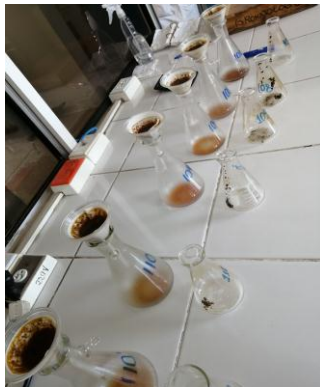
Determinación de grasa: grasas: M) Hidrólisis y filtrado, N) extractor de grasa, O) Secado
