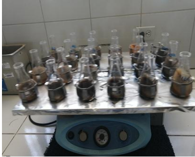
Método de Absorción atómica Olsen modificado K) Agitación orbital L) Filtrado M) Muestras filtradas N) Absorción atómica.
