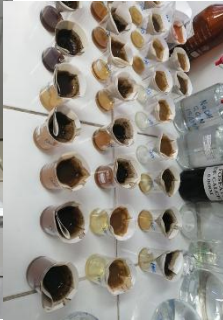
Método de Absorción atómica Olsen modificado K) Agitación orbital L) Filtrado M) Muestras filtradas N) Absorción atómica.
