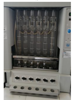
Determinación de Fibra: P) Muestra en dedos, Q) Desengrasado de la muestra, R) Muestra desengrasada, S) Extractor de fibra
