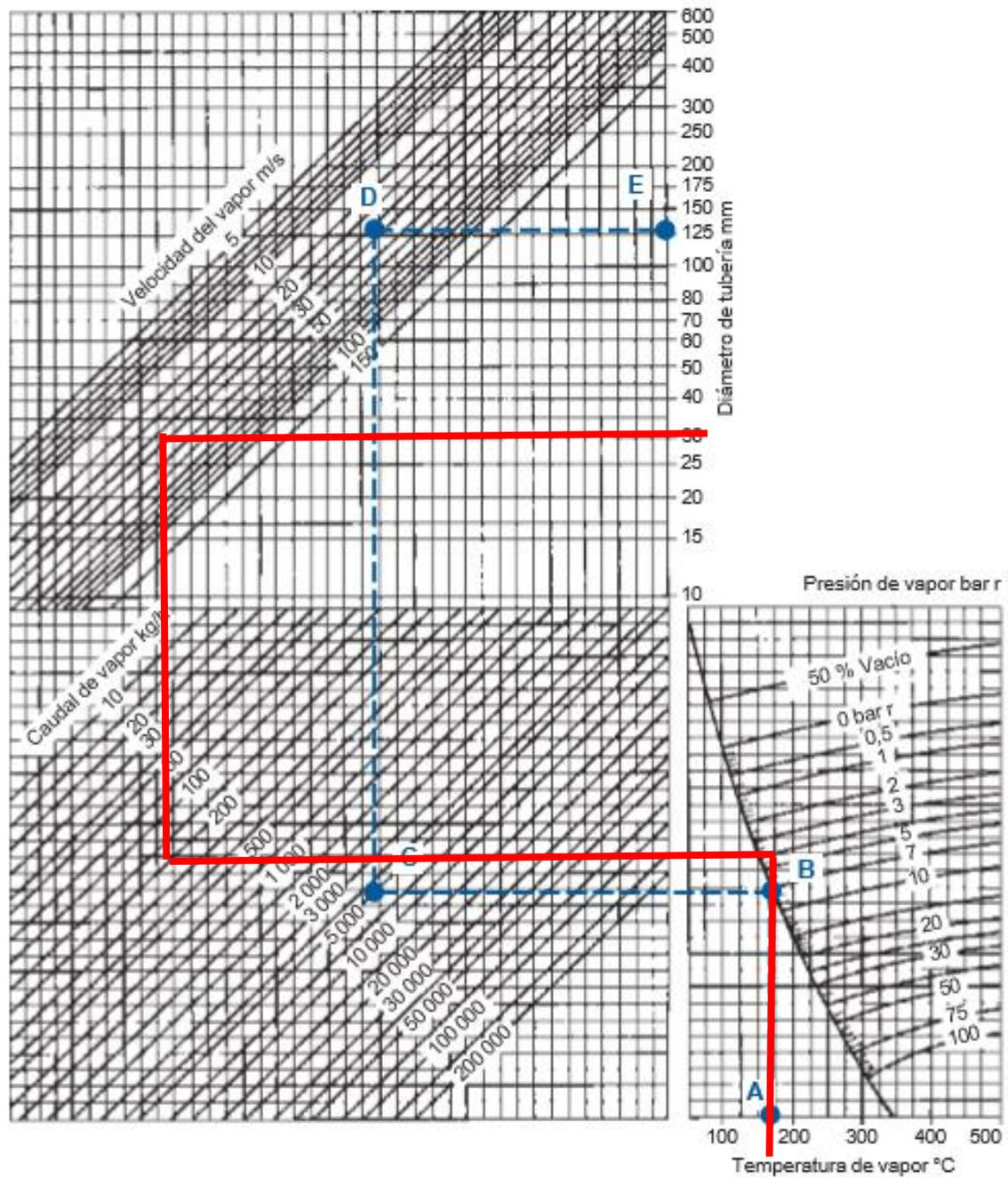
Gráfico para el dimensionamiento de tuberías para vapor saturado y vapor recalentado por el método de la velocidad [29].
