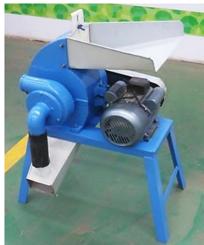
Figura 5. Molino de martillos [15]
