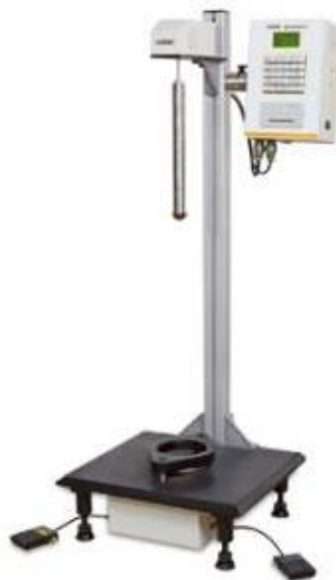
Figura 8. BMC-B1 Probador de resistencia al impacto de caída libre [21]
