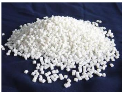
Figura 6. Partículas de resina reciclada [19]
