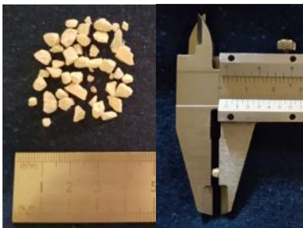
Figura 9. Trozos de resina con granulometría requerida. Elaborado por: Cristian Churo y Santiago Guamushig
