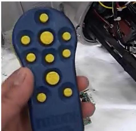
Control remoto RotorK usado para el ingreso a los modos de configuración del actuador. Elaborado por: Santiago Monta, 2019.
