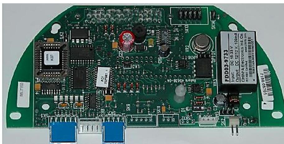
Tarjeta de interfaz del actuador vista superior. Fuente: (ModBus, 2019).
