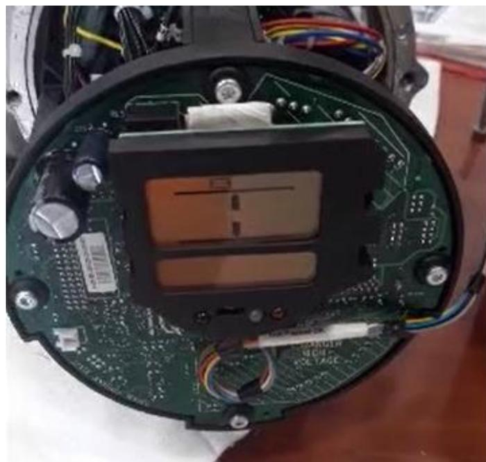
Display del actuador encendido y parcialmente cerrado. Elaborado por: Santiago Monta, 2019.
