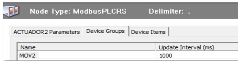
Dentro del SMC se crea una ventana ModBusPLCRS para el actuador 2 se le asigna una ID y etiqueta para su diferenciación con los demás actuadores. Elaborado por: Santiago Monta, 2019.
