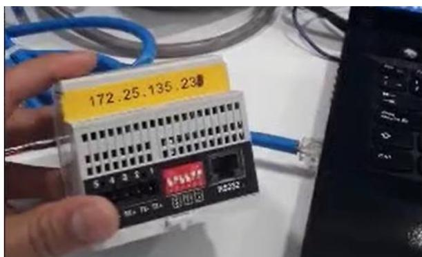
Gateway configurado con la IP mostrada en la imagen. Elaborado por: Santiago Monta, 2019.
