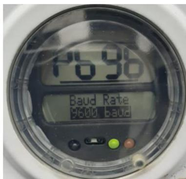
Pantalla para asignación de velocidad para la transmisión de datos al módulo ModBus. Elaborado por: Santiago Monta, 2019.
