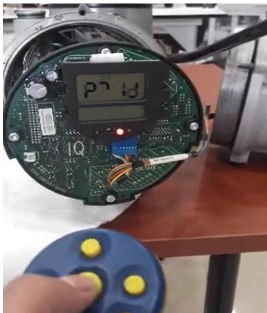
Configuración del actuador para establecer el control Remoto ModBus. Elaborado por: Santiago Monta, 2019.
