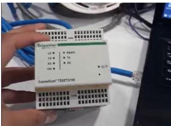
Gateway conectado y listo para el proceso de pruebas de comunicación. Elaborado por: Santiago Monta, 2019.
