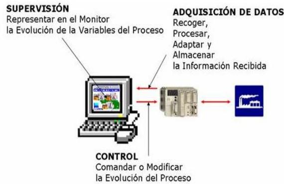
Funciones de paquetes SCADA para realizar la supervisión de un determinado proceso. Fuente: (Uniovi, 2019)
