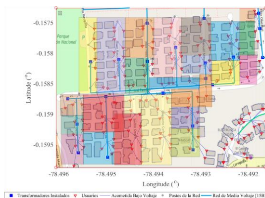
Figura 6. Sectorización de operación de cada transformador
