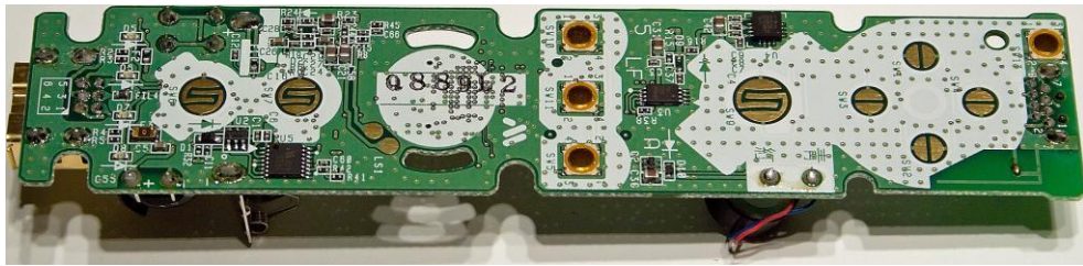
Figura 4. Imagen de la parte superior de la placa de circuito impreso del Wiimote
