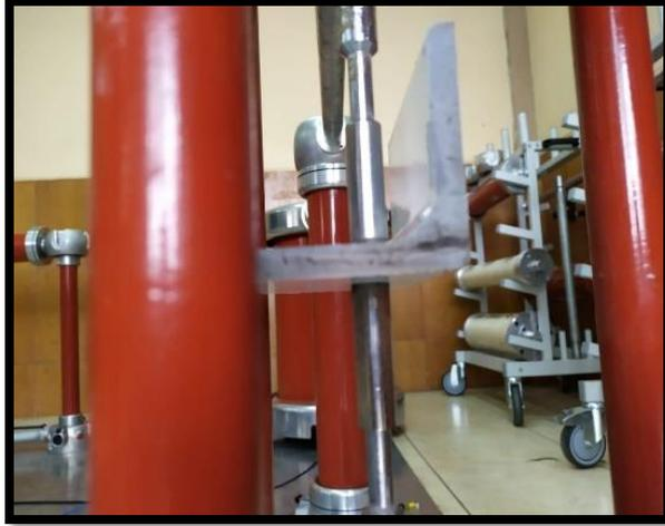
Figura 2.13 Configuración crítica de los electrodos.
