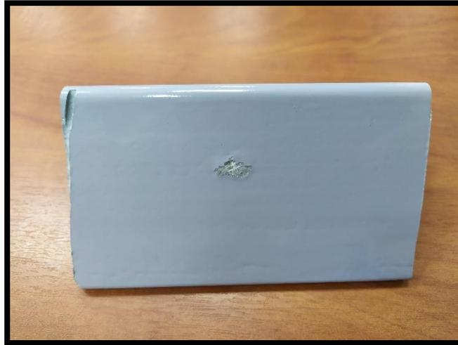
Figura 3.23 Cruceta de PRFV después de 15 impulsos tipo rayo de 64.22 kVp en ambiente seco.
