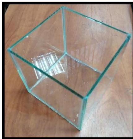
Figura 3.1 Recipiente de vidrio para estimación de la precipitación en pruebas de lluvia.
