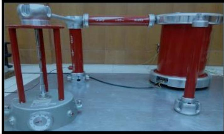
Figura 2.7 Medición directa de descargas parciales en ambiente seco.
