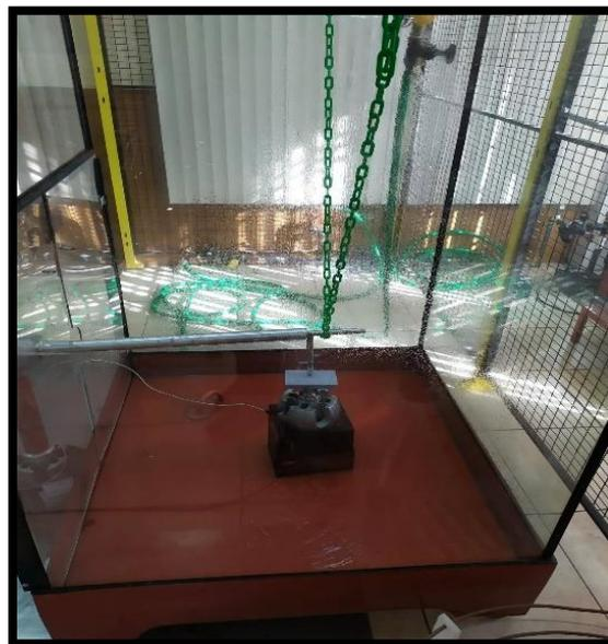
Figura 2.8 Medición directa de descargas parciales en ambiente húmedo.
