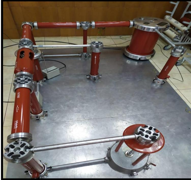
Figura 3.21 Circuito armado en el laboratorio de A.T. de la UPS para ensayos del BIL.
