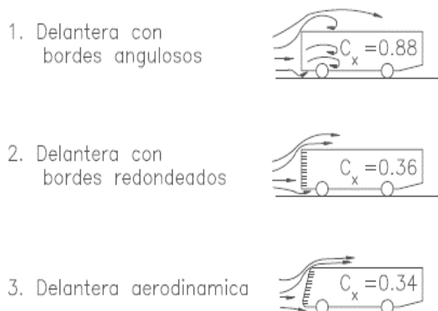
Figura 12. Relación entre la forma de la parte delantera del vehículo y el coeficiente de fricción. (Aparicio, 2016, p. 173)
