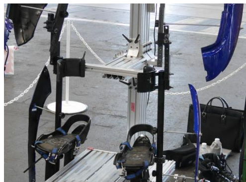
Figura 41. Extremidades inferiores de exoesqueleto Arrive. Fuente: [19].
