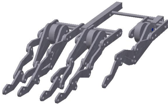
Figura 85. Esquema y diseño de la mano del exoesqueleto. Fuente: [Autores].
