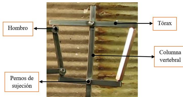
Figura 8. Tórax de exoesqueleto mecánico. Fuente:[ Web Empresa Eskeletonics].
