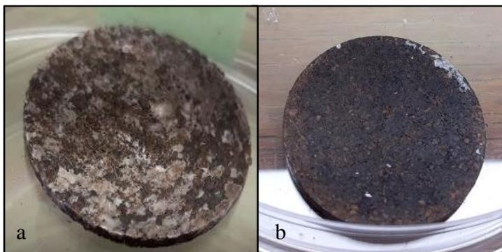
Imagen 22: Proceso de Degradación con Luz Artificial: a) Pastilla B/C - 70/30 ; b) Patillas C/B - 80/20
