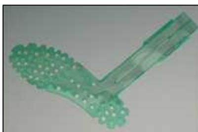
**Figura 22.** *Plantilla instrumentada Biofoot [24].*
