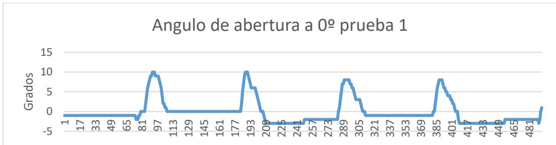
**Figura 53. Ciclo de marcha y medición de ángulos a 0° pie derecho.** Fuente: Autor
