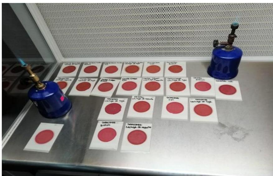
**Ilustración 35.** Placas Petrifilm TM previamente etiquetadas.
