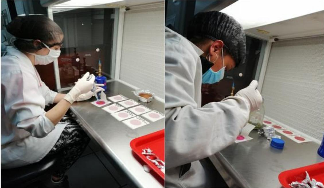
**Ilustración 36.** Inoculación de las muestras en la cámara de flujo laminar.
