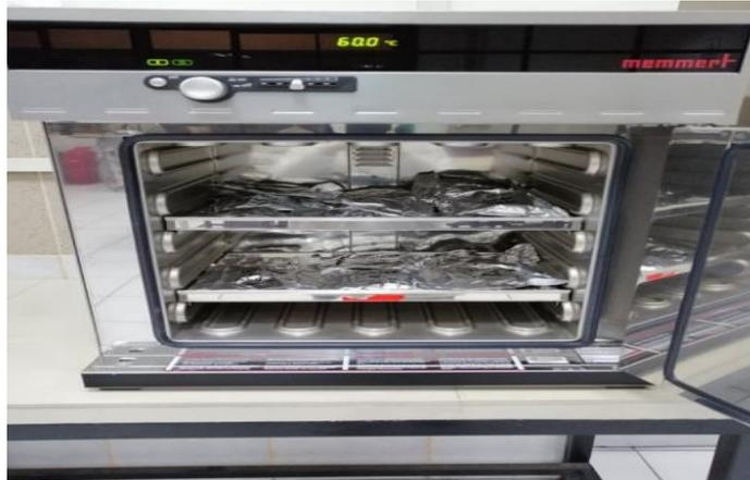
**Ilustración 51.** Secado de Muestras en la estufa a 60 ° C.
