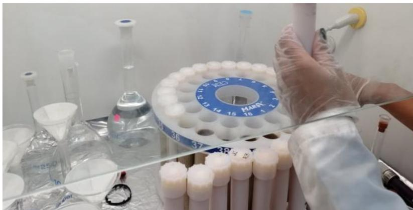
**Ilustración 45** Tubos con ácido nítrico y muestra listos para colocarse en el digestor.
