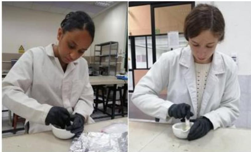
**Ilustración 42** Trituración de muestras con mortero.
