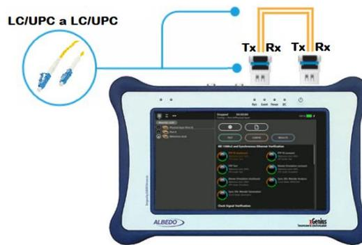
Figura 3.21 Diagrama de conexión para generación de tráfico
