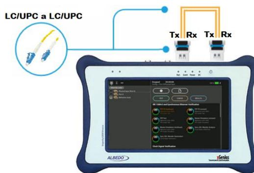
**Figura 2** Diagrama de conexión para generación de tráfico
