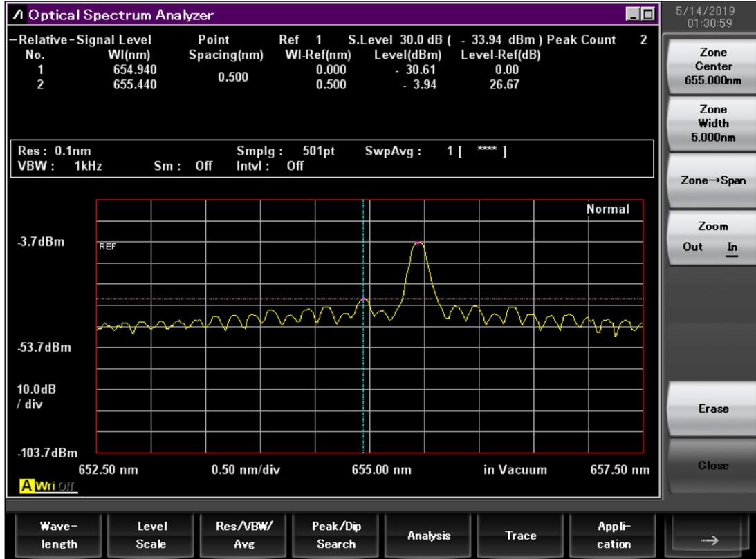
Figura 3.16 Espectro del láser Fabry Perot con longitud de onda 650 nm luz visible del OTDR
