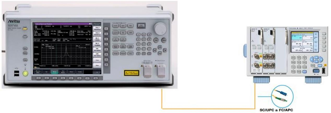
Figura 1. Esquema de Conexión OSA – Fuente Óptica
