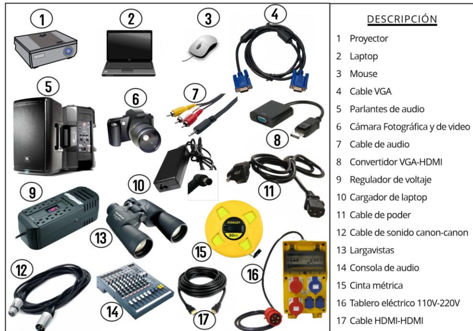
Figura 5.2 Equipos y elementos necesarios para el montaje de un sistema Video-Mapping Fuente: [Autores]
