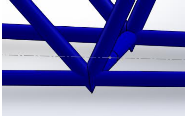
Ilustración 50/ Unión de tubos con imperfecciones
