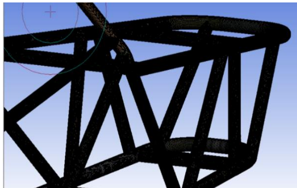
Ilustración 58/ Refinamiento del mallado del chasis
