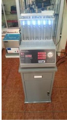
**Figura 3.29.** Banco para limpieza de inyectores Machines. (Training, 2019)
