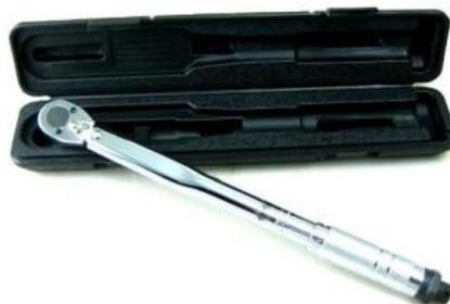
**Figura 3.37.** Torquímetro Tekton. (Training, 2019)
