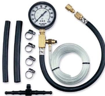
**Figura 3.31.** Medidor de presión de gasolina. (Training, 2019)
