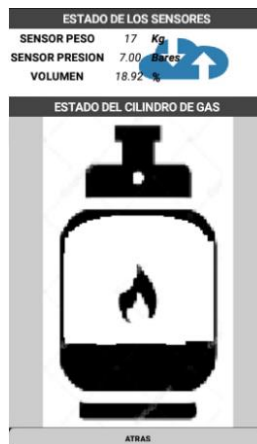
Figura 3.22 Interfaz en el móvil de cilindro de gas doméstico con un valor inferior al 25% del GLP total contenido en el cilindro
