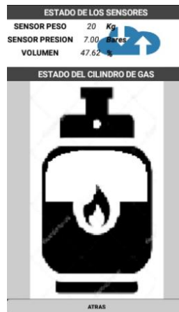
Figura 3.21. Interfaz en el móvil de cilindro de gas doméstico con un valor inferior a la mitad del GLP total
