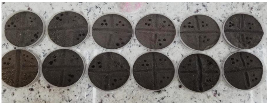
Figura 12: Muestras de suelo para la repelencia al agua a 40°C
