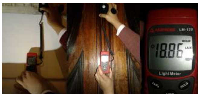
Figura 15. Mediciones tomadas en la iglesia de la merced.
