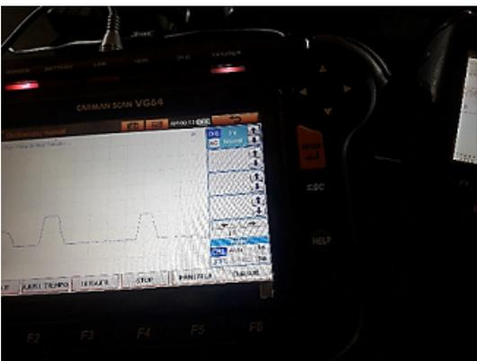
**Figura 8.** Señal del sensor TPS. Elaboración propia
