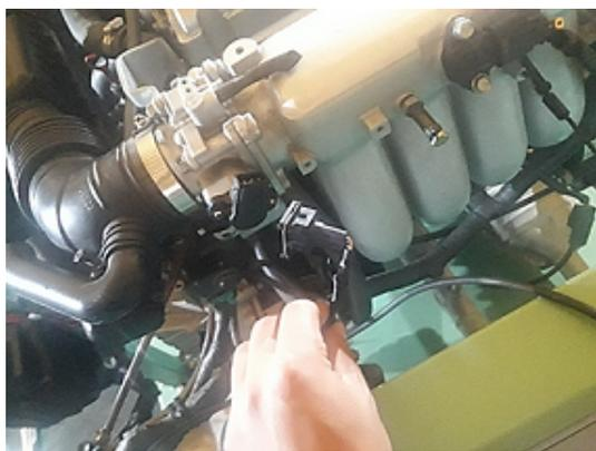
**Figura 17.** Desconexión del sensor TPS. Elaboración propia
