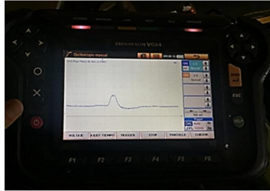
**Figura 14.** Señal del sensor MAF. Elaboración propia
