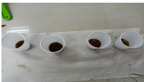
FOTO 3. Mezclado de la muestra con la solución salina y el proceso de cernido.
