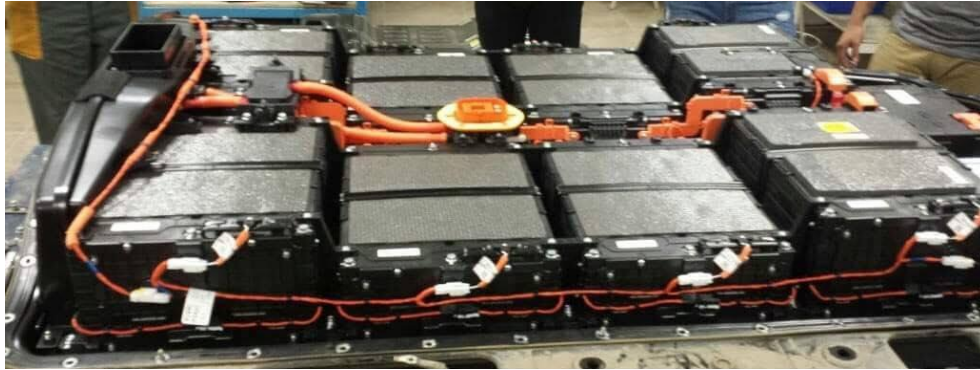
Figura 16: Paquete de batería de alta tensión Kia Soul EV. Fuente: Autores.
