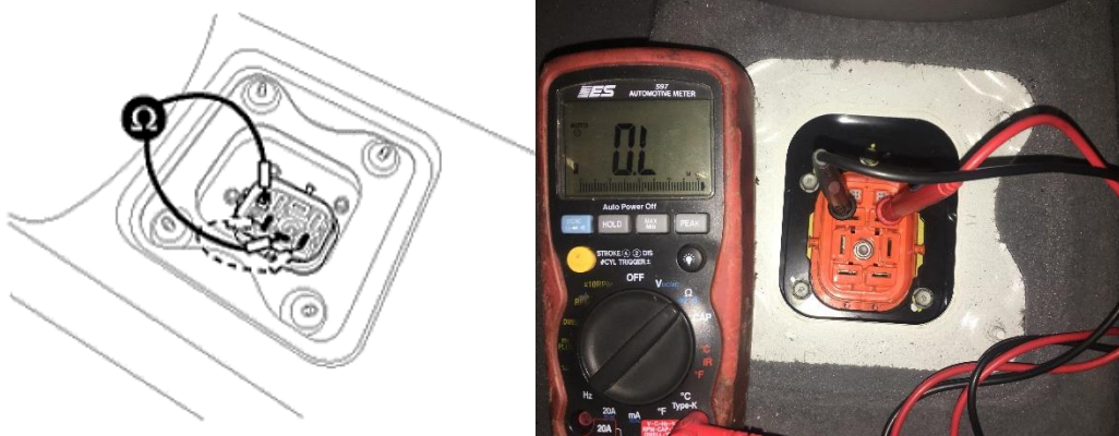
Figura 47. Diagrama de medición de resistencia del fusible. Fuente: Autores.
