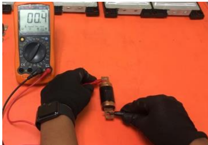
Figura 49. Medición de la resistencia del fusible. Fuente: Autores
