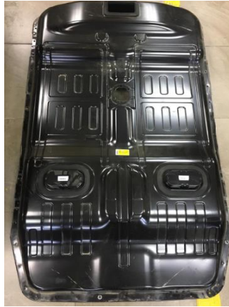
Figura 14: Paquete de batería de alta tensión. Fuente: Autores.
