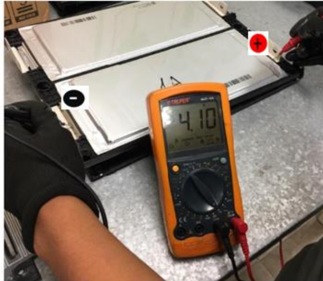
Figura 67: Comprobación de celda. Fuente: Autores.
