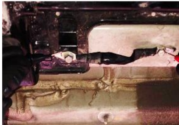
Figura 30: Cable de masa de la batería de alta tensión. Fuente: Autores.
