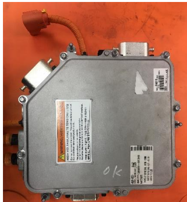
Figura 10: Bloque de unión de alto tensión Fuente: Autores.
