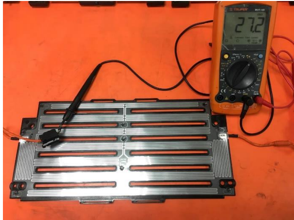
Figura 61: Comprobación del calefactor. Fuente: Autores
