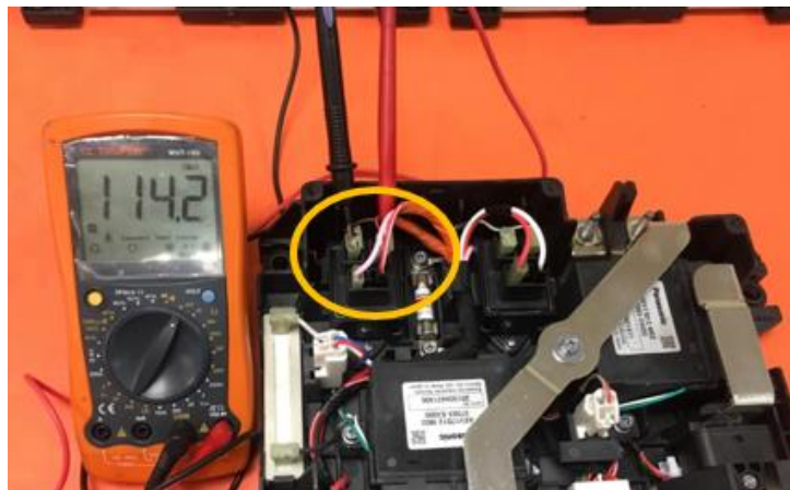
Figura 54: Comprobación del relé del calefactor. Fuente: Autores.
