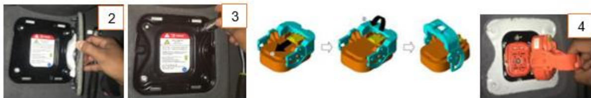
Figura 23: Pasos de desconexión del interruptor de seguridad (Jumper) de la batería de alta tensión.
