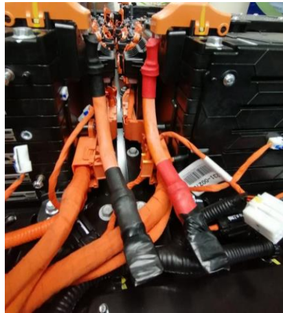
Figura 78 Cableado de alta tensión color naranja. Fuente: Autores
