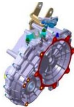
Figura 13: Engranaje reductor que se presenta en Kia Soul EV. Fuente: Kia, 2018.
