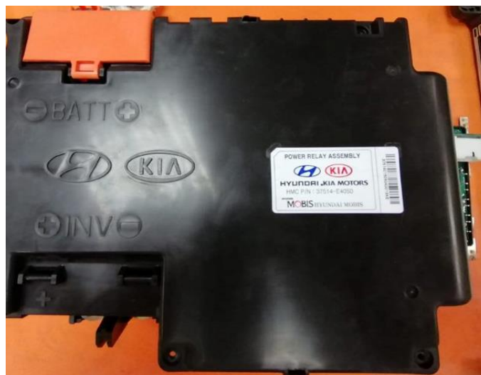
Figura 41: Conjunto PRA. Fuente: Autores.
