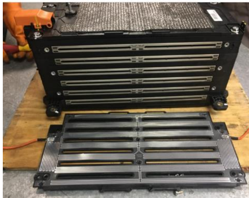
Figura 60: Calefactor del módulo de batería. Fuente: Autores.
