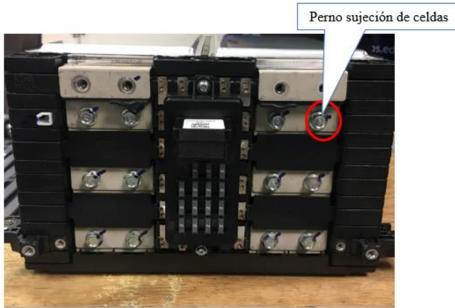
Figura 63: Pernos de sujeción celdas. Fuente: Autores.
