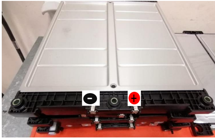
Figura 71: Celdas del módulo de batería. Fuente: Autores.
