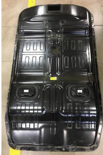
Figura 33: Paquete de batería de alta tensión. Fuente: Autores.
