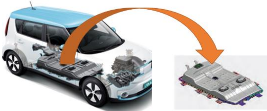
Figura 15: Disposición de la batería en el automóvil. Fuente: Autores.
