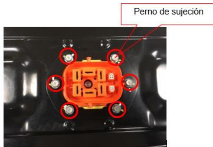
Figura 35: Pernos de sujeción del interruptor de seguridad. Fuente: Autores.
