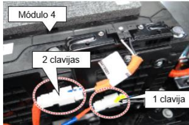
Figura 76: Conexión sensores del módulo. Fuente: Autores.
