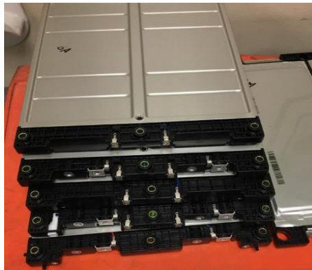
Figura 66: Celdas del módulo de la batería. Fuente: Autores.
