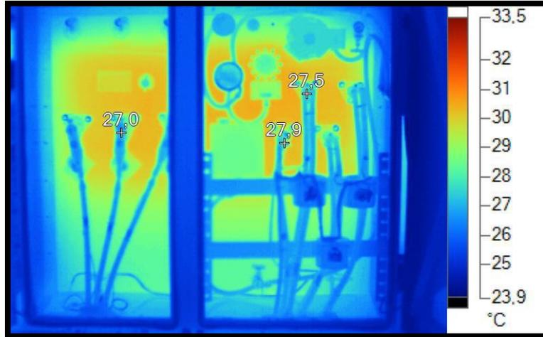
*Ilustración 109: Inspección termográfica de un transformador de servicios auxiliares, fuente: CELEC EP TRANSELECTRIC SE Pascuales, Guayaquil – Ecuador.*
