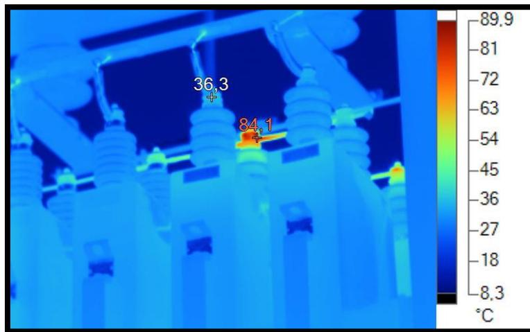
*Ilustración 110: Identificación de punto caliente, fuente: CELEC EP TRANSELECTRIC SE Pascuales, Guayaquil – Ecuador.*
