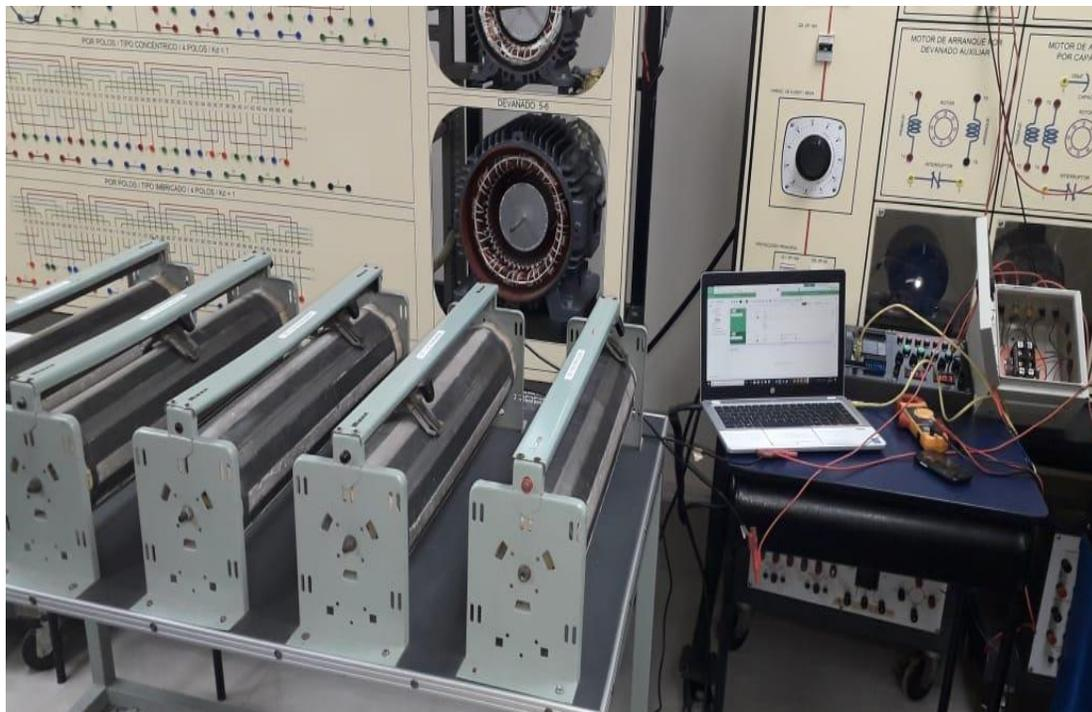
**FIGURA 61. FUNCIONAMIENTO AÑADIENDO RESISTENCIA AL MOTOR MONOFÁSICO**
