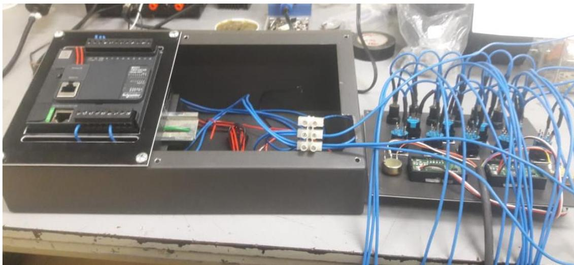
**FIGURA 11.** CABLEDO INTERNO DEL MÓDULO DE PRUEBAS
