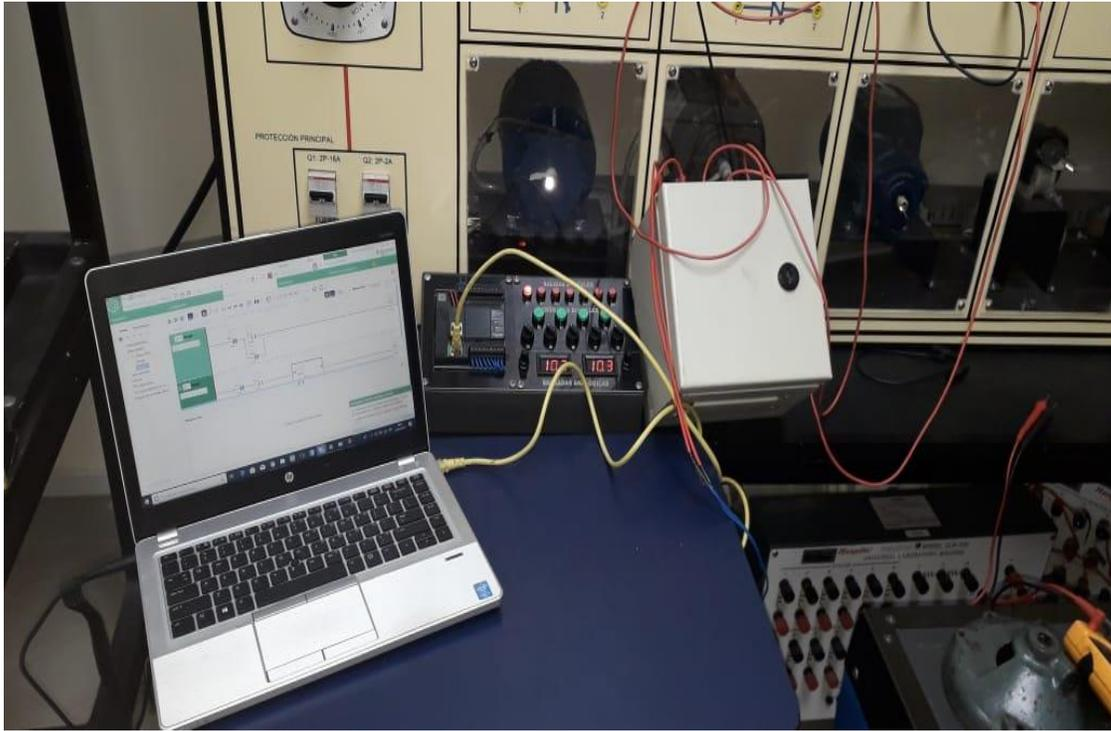
**FIGURA 64.** INSTALACIÓN ORDENADOR CON EL MÓDULO DE PRUEBAS RELÉ AL BANCO DE PRUEBAS
