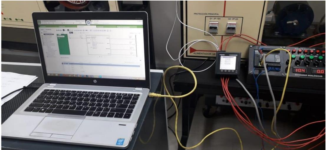
**FIGURA 18.** COMUNICACIÓN ENTRE EL ORDENADOR PORTÁTIL Y EL ANALIZADOR DE REDES PM5100 SCHNEIDER.
