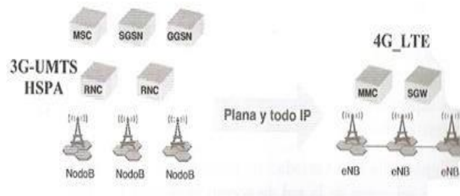
Figura 1.13 Arquitectura plana de LTE. Fuente: Obtenido de [4, 11]
