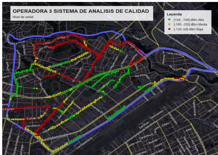
Figura 3.20 Cobertura operativa 3 normativa de la operadora Fuente: Los Autores
