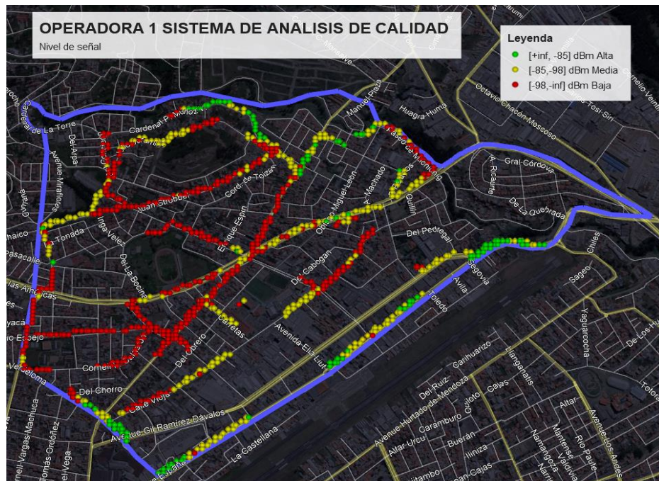
Figura 3.14 Cobertura operadora 1 nivel de señal del SMMM
