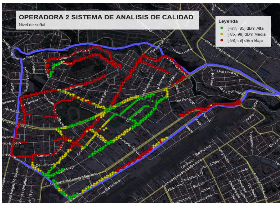
Figura 3.18 Cobertura operadora 2 normativa del SAMM Fuente: Los Autores
