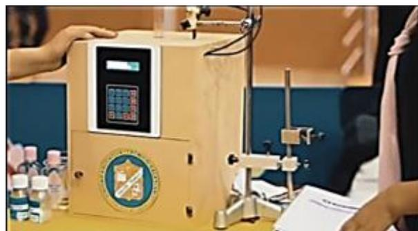
Figura 3. Viscosímetro construido
