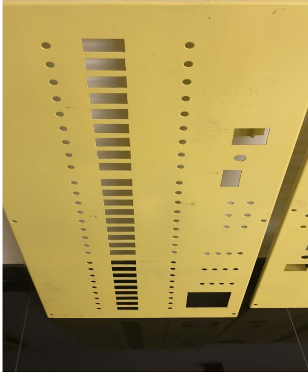
FIGURA 18.ACABADOS FINALES DE PINTURA # 2
