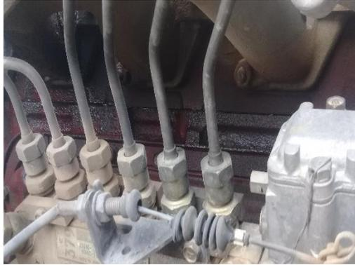
***VISTA DEL MOTOR Y BOMBA DE INYECCIÓN***
