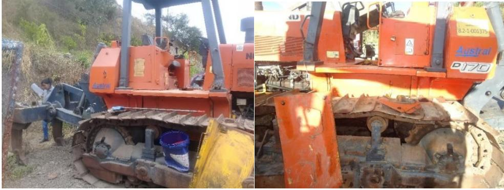
**Figura 44:** Vista posterior y tren de rodaje. **Fuente:** Autores.
