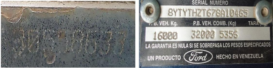
***VISTA DEL NÚMERO DEL MOTOR Y PLACA DE IDENTIFICACIÓN DEL CHASIS***
