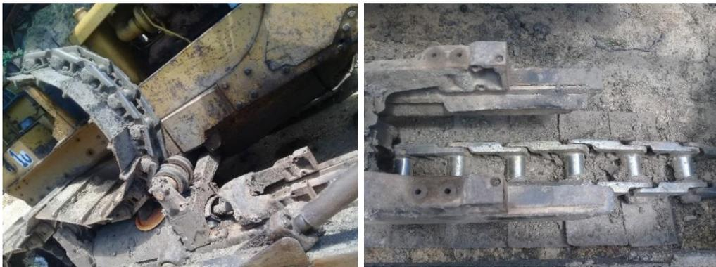
***VISTA DEL TREN DE RODAJE DESMONTADO***
