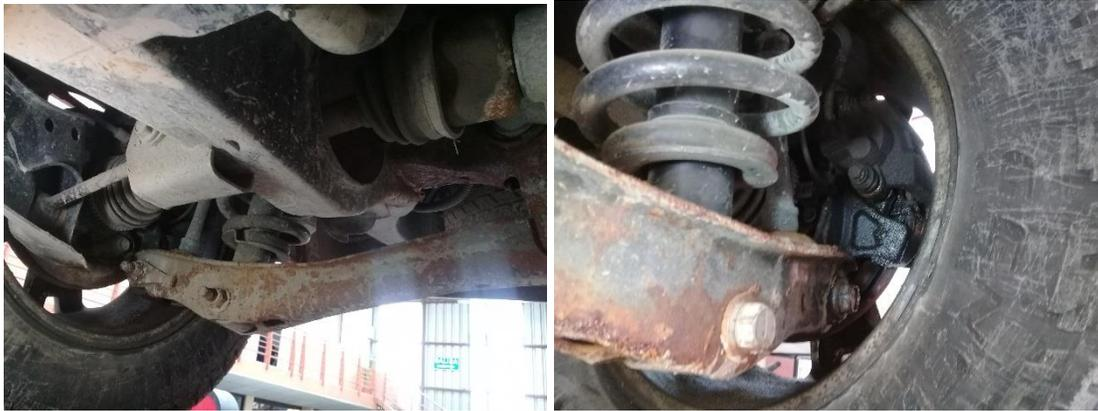
***VISTA DE LA SUSPENSIÓN POSTERIOR Y FUGAS DE LIQUIDO DE FRENO***
