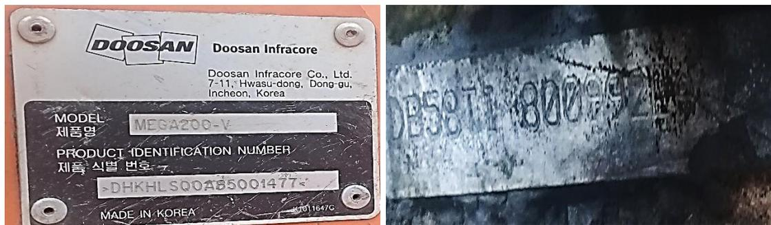
***VISTA DE LA PLACA DE IDENTIFICACIÓN DEL CHASIS Y MOTOR***
