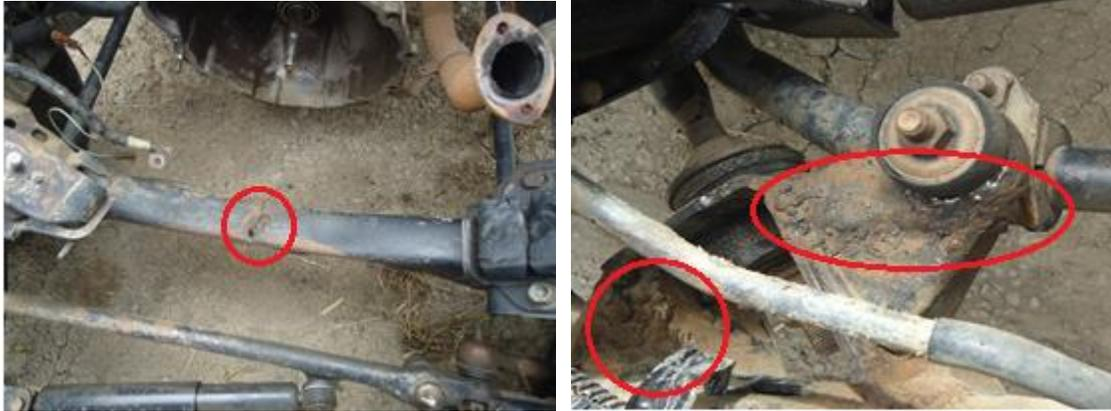
***VISTA DEL HABITÁCULO DEL MOTOR, CON PRESENCIA DE SUELDA***
