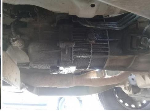
***VISTA DE LA BOMBA DE FRENO Y LA CAJA DE CAMBIOS CON FUGAS DE ACEITE***
