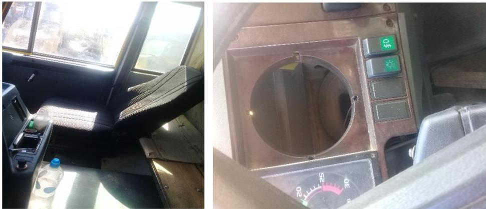
***VISTA INTERNA DE LA CABINA Y FALTA DEL ODÓMETRO***
