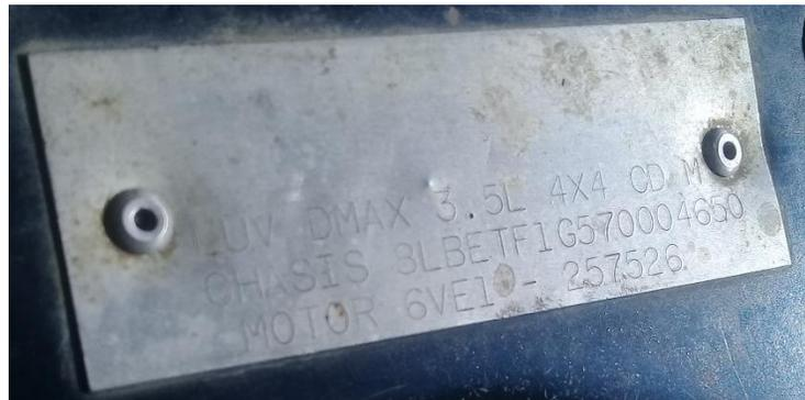
**VISTA DE LA PLACA DE IDENTIFICACIÓN DEL CHASIS Y MOTOR**
