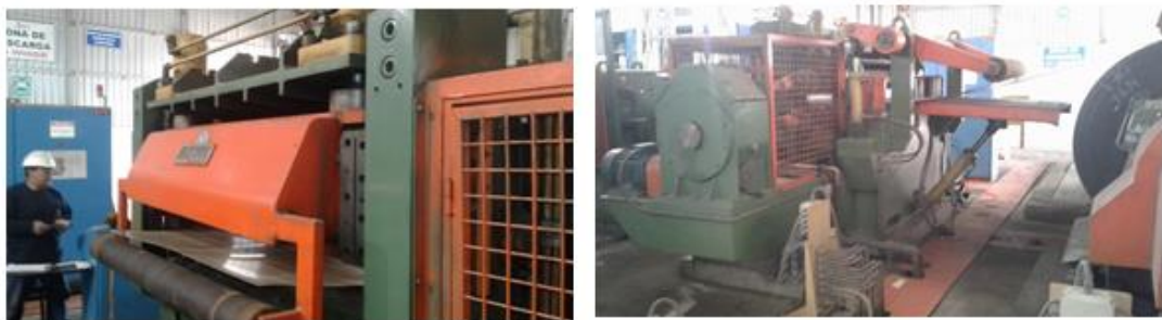
Figura 19. Meza de entrada, guías de centrado, Rodillos de tiro y cizalla guillotina. [Autores]
