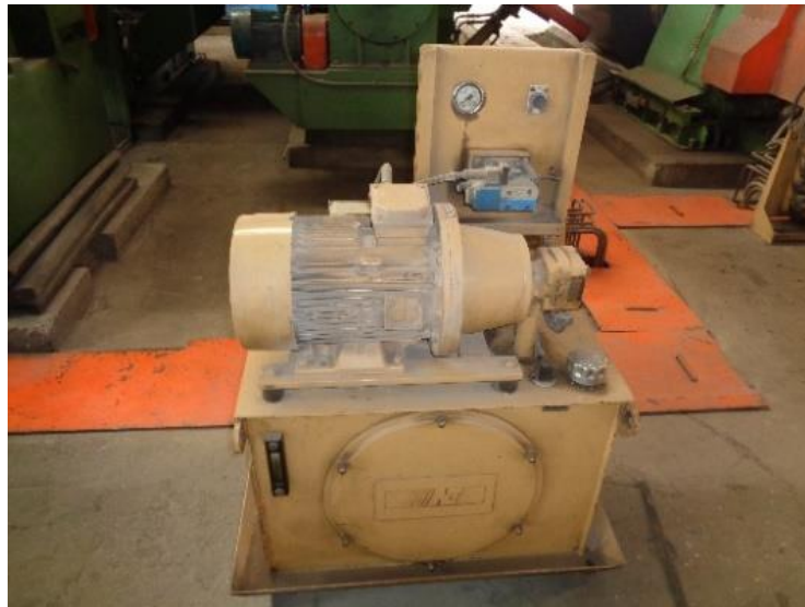
Figura 34. Grupo hidráulico. [Autores]
