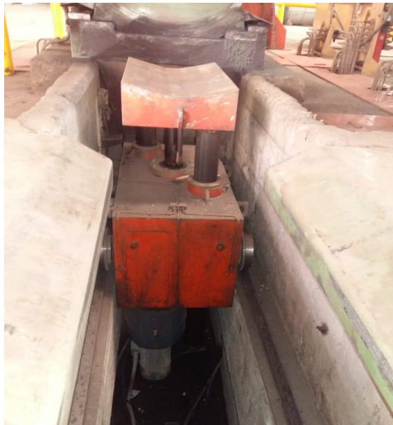
Figura 15. Pistón elevador, guías de mesa y moto-reductor. [Autores]
