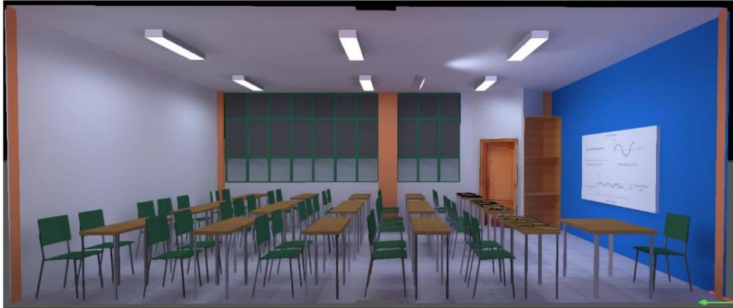
Figura 3.5 Simulación del Aula N° 20 con una temperatura de color 6500K DIALux con proyector encendido.
