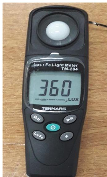
Figura 2.5 Luxómetro utilizado en la medición del aula N°20. Fuente: Autores
