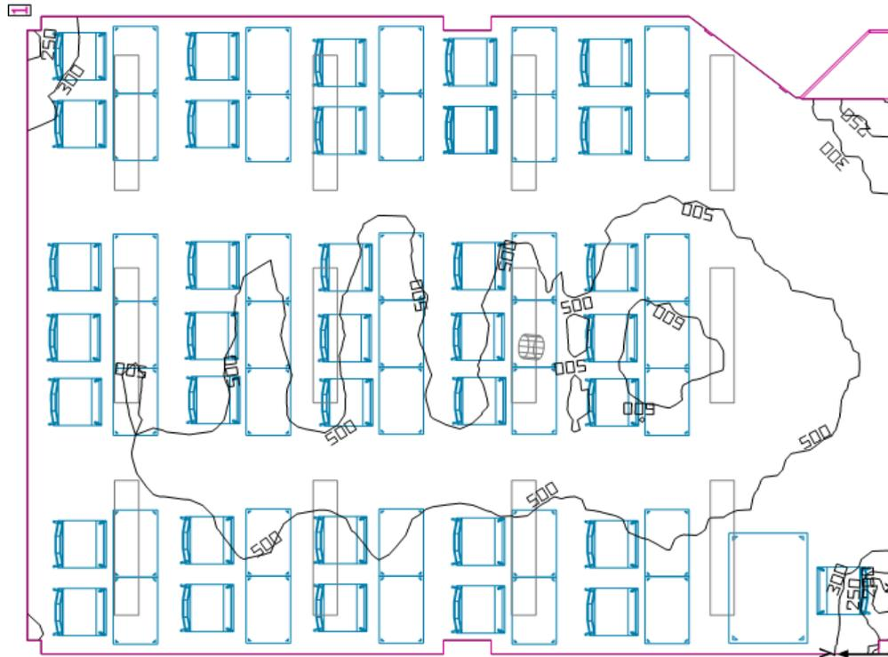
Figura 3. 14 Curva IsoLux del Aula con una temperatura de 6500K con proyector encendido. Fuente: Autores
