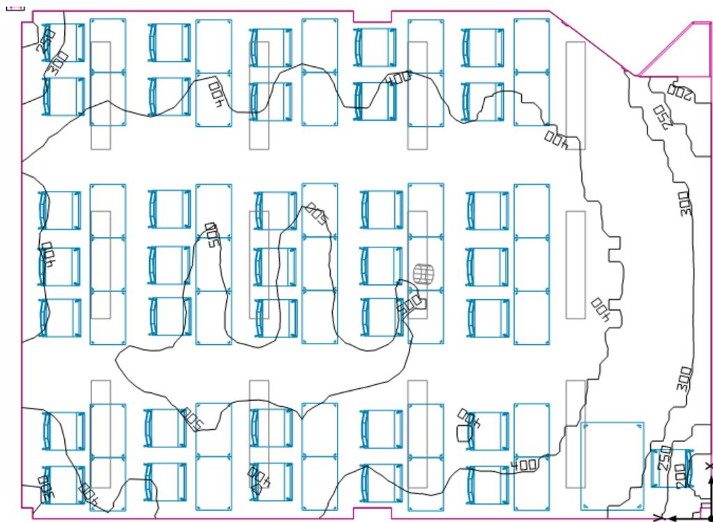
Figura 3. 12 Curva IsoLux del Aula con una temperatura de 6500K con proyector apagado. Fuente: Autores
