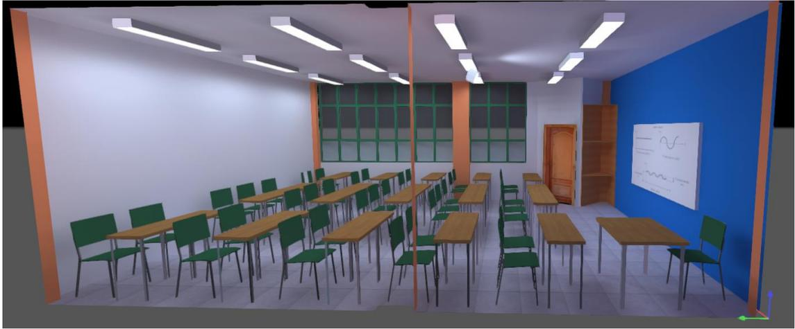
Figura 3. 15 Simulación del Aula N° 20 con una temperatura de color 6500K DIALux con dos circuitos independientes. Fuente: Autores
