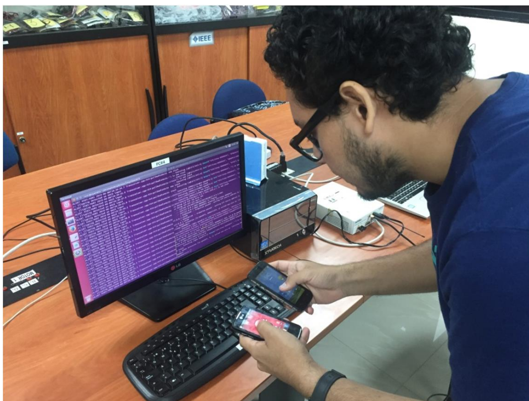
Figura 85. Suscripción de dos terminales móviles a la red GSM de OpenBTS.
