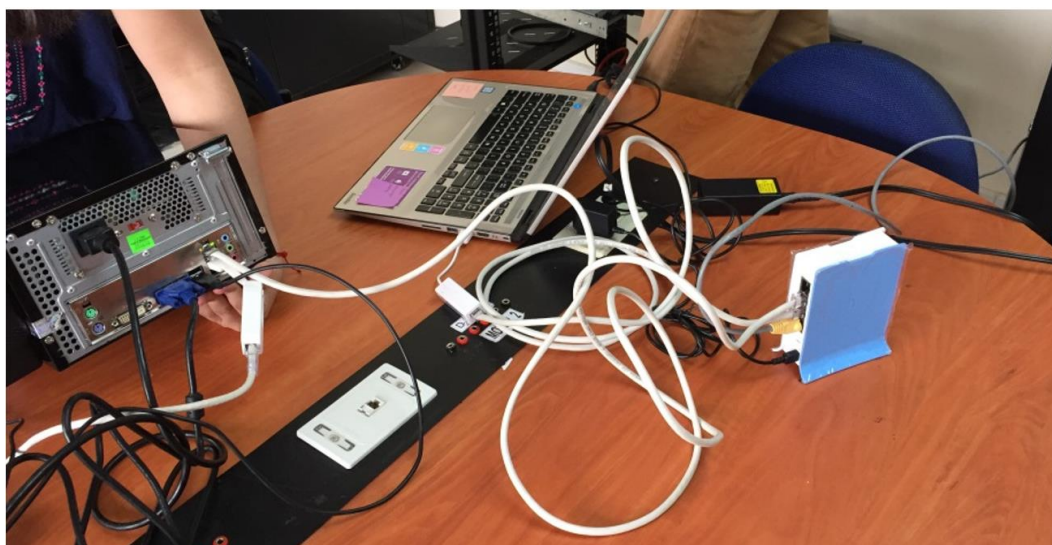
Figura 72. Interconexión de los servidores Asterisk y OpenBTS mediante el AP. Fuente: Los autores. Elaborado: Los autores.
