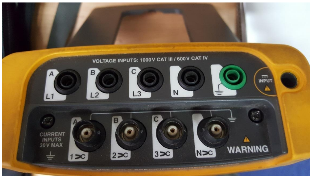
Figura 3-4 Pines de conexión del Fluke 435.
