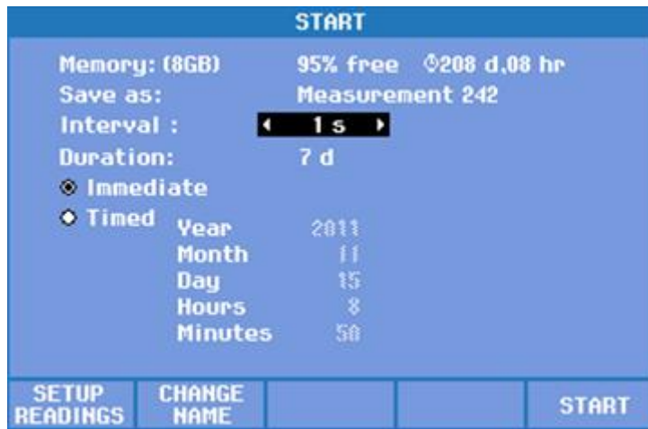
Figura 3-11 Configuración del intervalo de registro de datos y periodo de medición.
