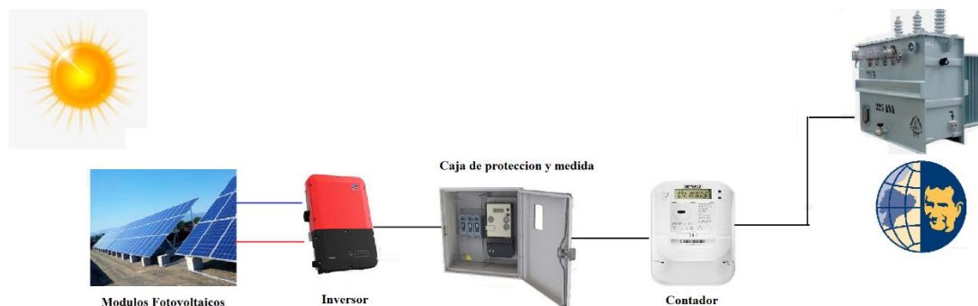
Figura 1-1 Configuración fotovoltaica conectada red.[12]
