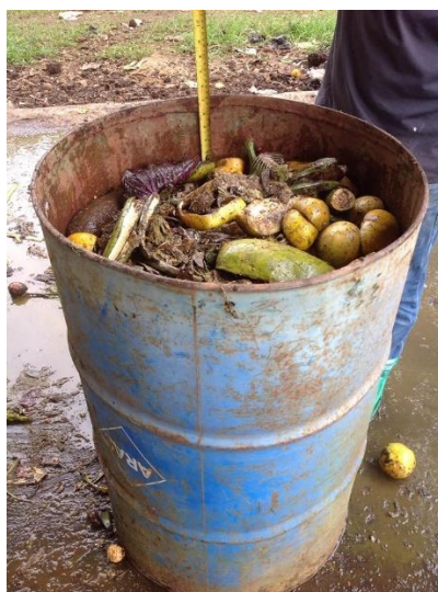
Ilustración 12. Determinación de densidad de residuos inorgánicos compactados
