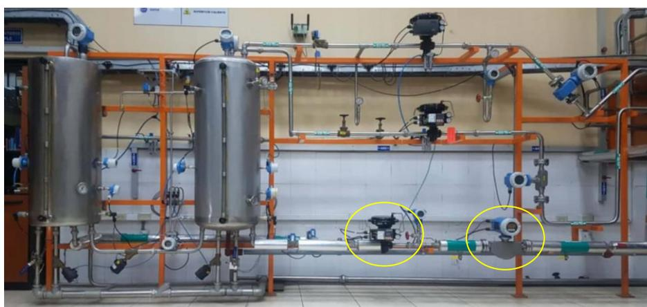
Figura 1.1 *Tuberías, sensores y contenedores de la planta de control y procesos A del laboratorio LACTI*
