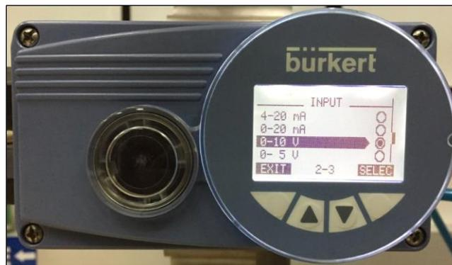
Figura 3.5 Seleccionar tipo de Entrada posicionador Burkert 8792.
