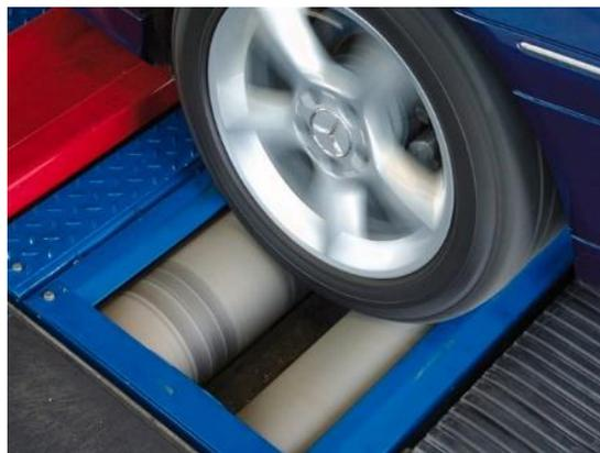
*Figura 5. 6. Banco Velocímetro. Fuente: (Maha Maschinenbau Haldenwang, 2019)*
