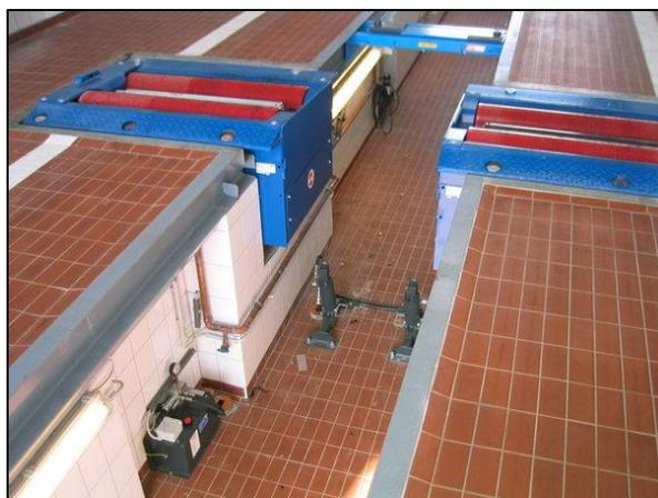
*Figura 5. 5. Banco de Pruebas para Frenos. Fuente: (CAPELEC, 2019)*
