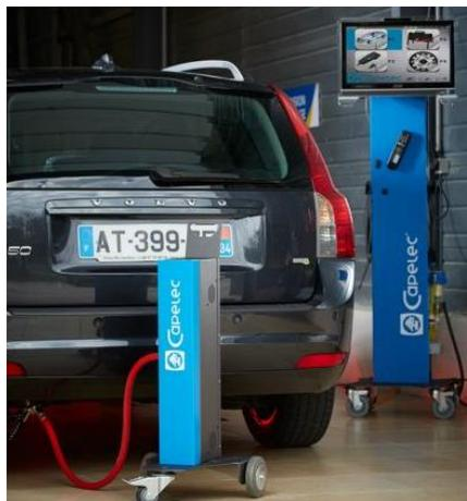
*Figura 5. 10. Analizador de Gases. Fuente: (CAPELEC, 2019)*
