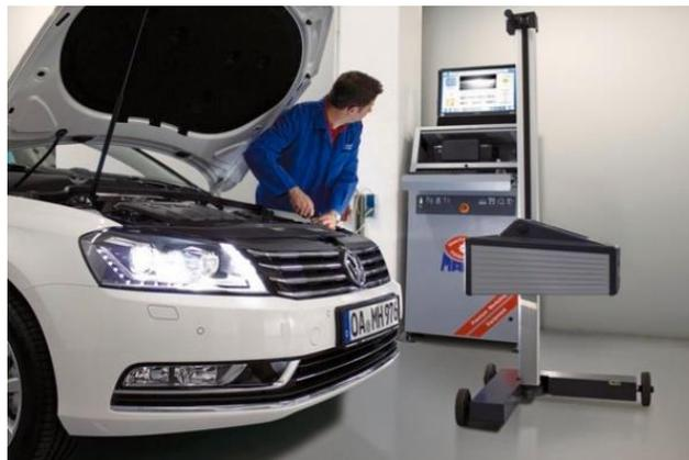
*Figura 5. 7. Luxómetro. Fuente: (Maha Maschinenbau Haldenwang, 2019)*
