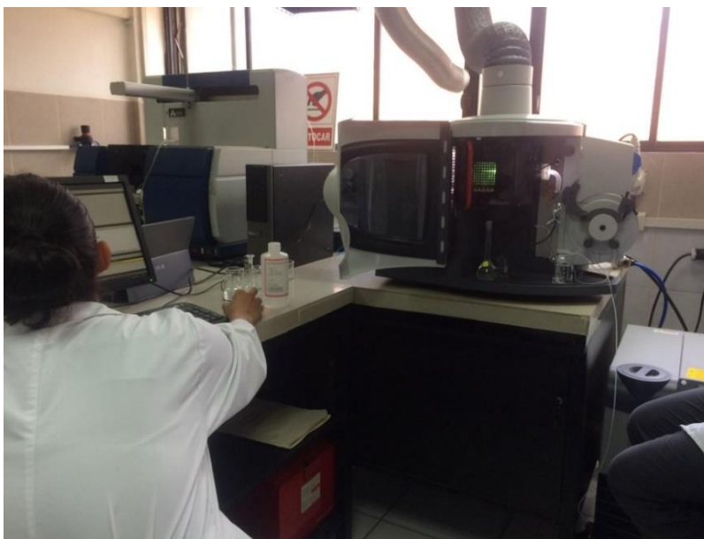
Figura 22. Corrida de muestras en Espectrómetro Emisión Óptica Acoplado al plasma inductivamente (ICP/OES).
